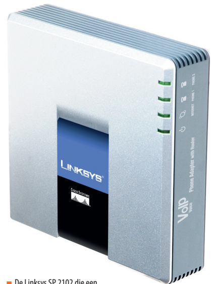
De Linksys SP 2102 die een gewone telefoon onderdeel maakt van een VoIP-oplossing.
